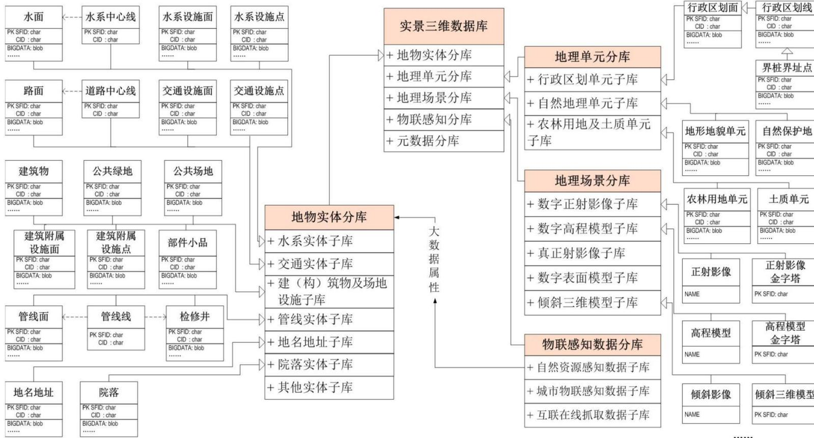
图 E.1 实景三维数据库逻辑架构
