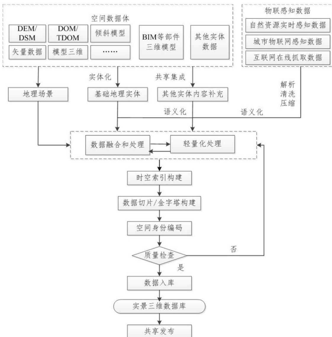
图 1 实景三维建设技术路线图
